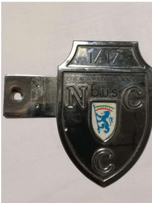
La targa esterna verrà apposta utilizzando una vite di supporto della targa d'immatricolazione.
